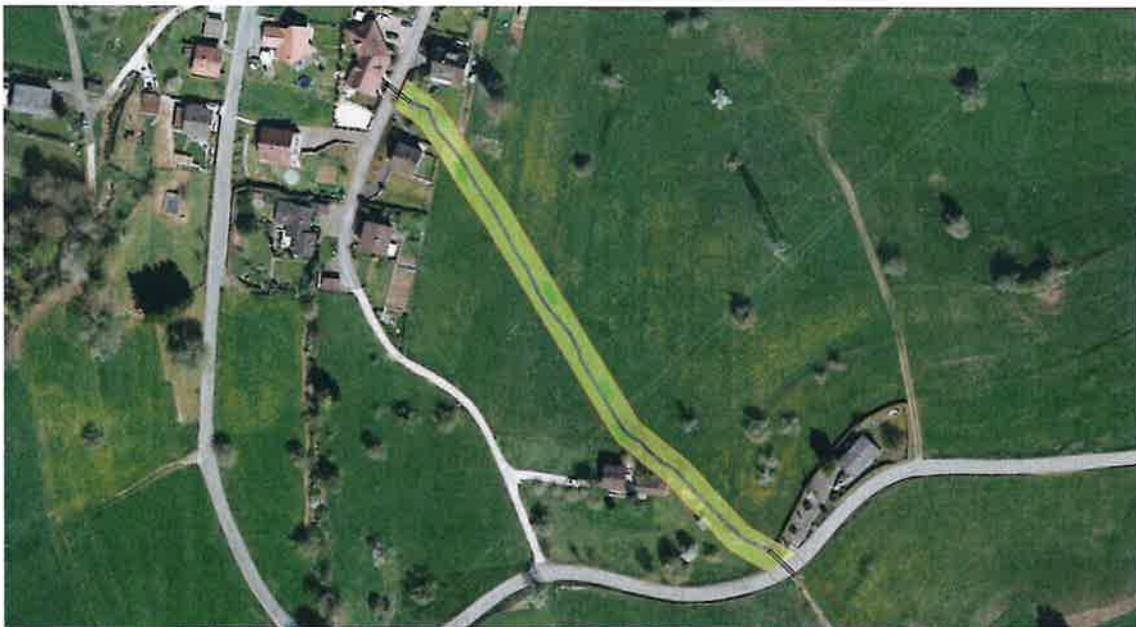
Abb. 15: Der Verlauf des Chueretsrütibächlis in der Falllinie im Falle einer Ausdolung. Der grüne Bereich, rot umrandet ist der Gewässerraum von 11m Breite.
